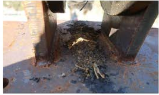
图7 3#滑轮下方钢丝绳断丝
