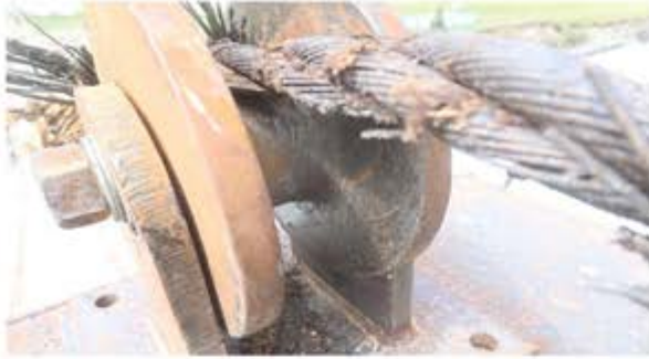
图6 3#滑轮内侧刮擦痕迹
