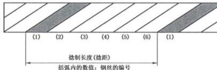
图 6 1\times 7 结构钢绞线捻距长度示意图
